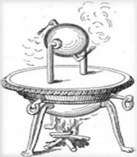
Cuando calentamos el tanque de agua y entra en ebullición, el vapor de agua asciende por los tubos hasta el balón y sale al exterior a través de las terminaciones acodadas produciendo el movimiento rotacional de la esfera en virtud de la fuerza reactiva del vapor.
